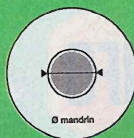
2. Mandrin : diamètre du rouleau cartonné, au centre de la bobine.
